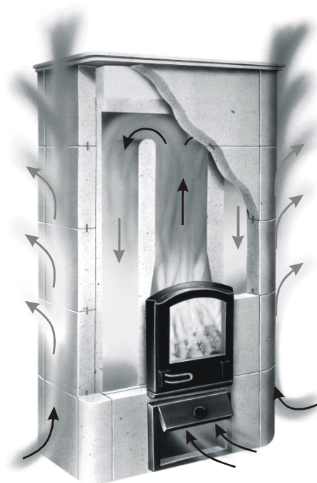
Kuva 4.17. Varaavan tulisijan toimintaperiaate. (Tulikivi Oy:n kuva-arkisto)
