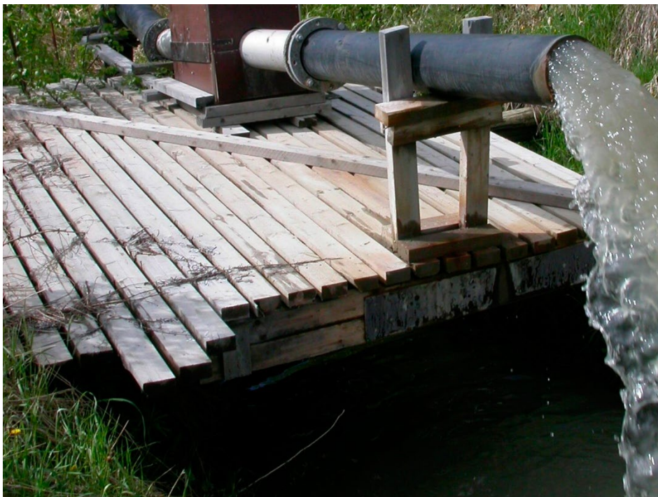
Kuva 3. Avolouhoksesta ja maanalaisesta kaivoksesta pumpataan vettä louhostilojen kuivana pitämiseksi. Kuva: © P. Frattini, GTK.
