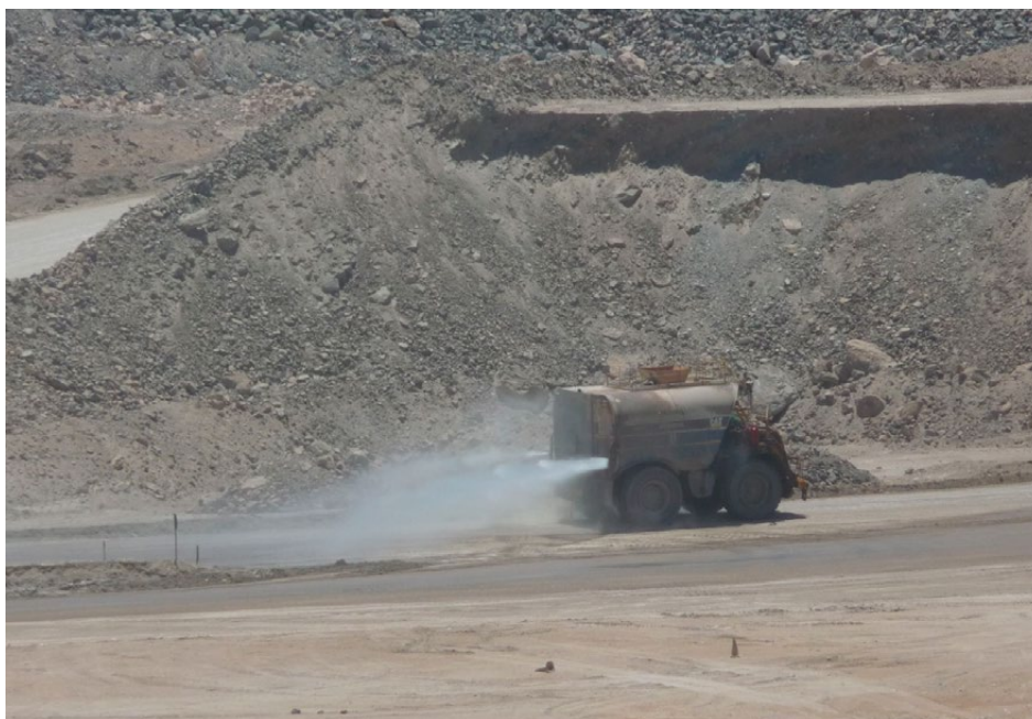
Kuva 19. Kuljetusväylien kastelu vähentää pölyämistä. Kuva. © T. Kauppila, GTK. Fig. 19. Wetting of haul roads to reduce dusting. Photo. © T. Kauppila, GTK.
