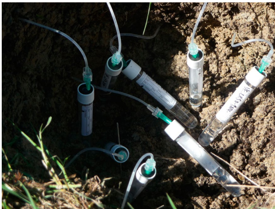
Kuva 17. Huokosveden keräämistä vajovesivyöhykkeestä. Kuva: © T. Kauppila, GTK. Fig. 17. Collecting pore water from the vadose zone. Photo: © T. Kauppila, GTK.
